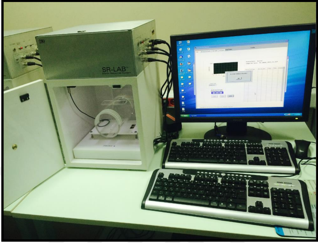
Şekil-5 İrkilme refleksi ölçüm cihazı (laboratuvarımızda kullanılan cihaz)
