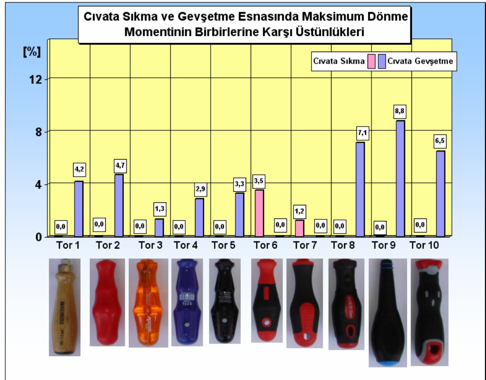
Şekil 5.6. Yağlı elle yapılan cıvata sıkma ve cıvata gevşetme esnasındaki maksimum dönme momentlerinin birbirlerine karşı üstünlükleri
