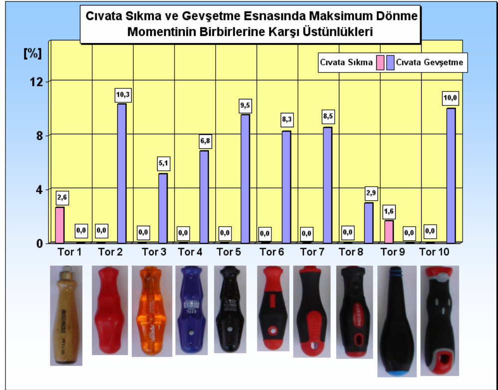
Şekil 5.2. Kuru elle yapılan cıvata sıkma ve gevşetme esnasındaki maksimum dönme momentlerinin birbirlerine karşı üstünlükleri
