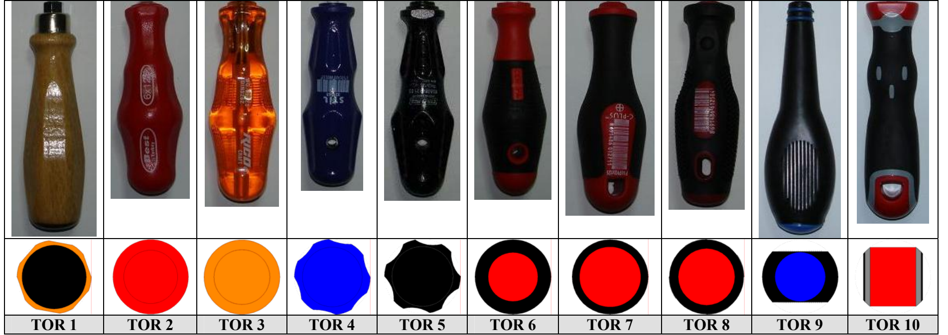
Şekil 3.1. Deneylerde kullanılan 10 farklı tornavidanın sapları ve kesit alanları
