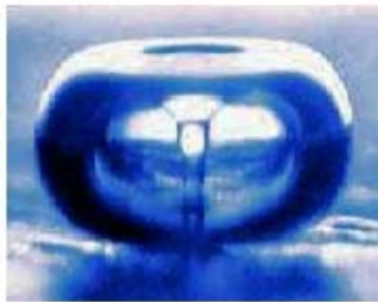
Şekil 2.6. Kaviteasyon baloncuğunun oluşumu ve katı yüzey yakınında kaviteasyon mikrojetleri (Öztürk 2010)
