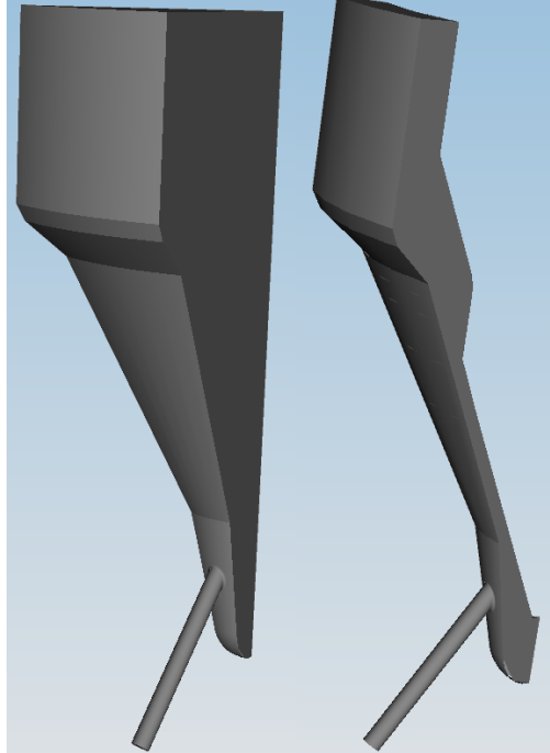
Şekil 3.6. İğneli ve iğnesiz akış CAD modelleri
