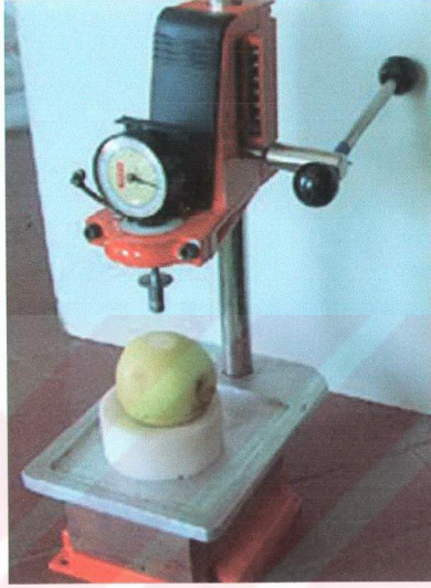
řekil 3.13. Penetrometre ölçüm sistemi
