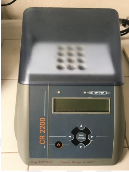
Şekil 3.7 KOİ test ölçümünde kitlerin ısınması için kullanılan CR 2200 termoreaktör
