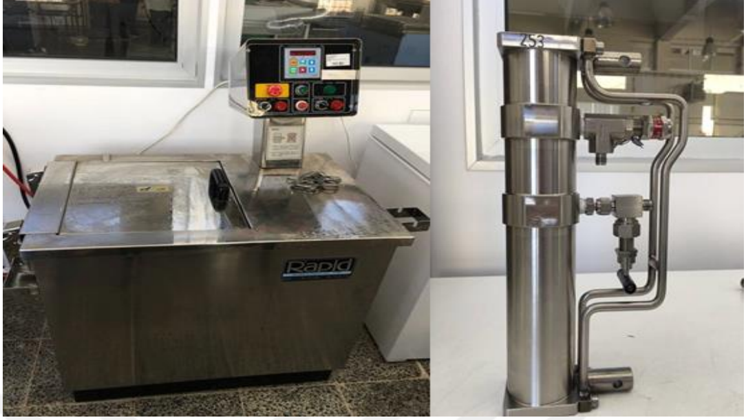
Şekil 3.1 Süperkritik karbondioksit denemelerinin yapıldığı yağ banyosu ve yüksek basınca dayanıklı tüpler
