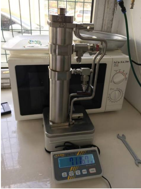
Şekil 3.4 Tüplerin ölçüldüğü KERN PCD hassas terazi
