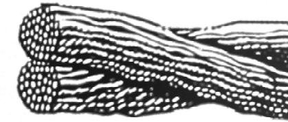
Şekil 2.4. Textürize iplik eninekesiti (Coats 1998)
