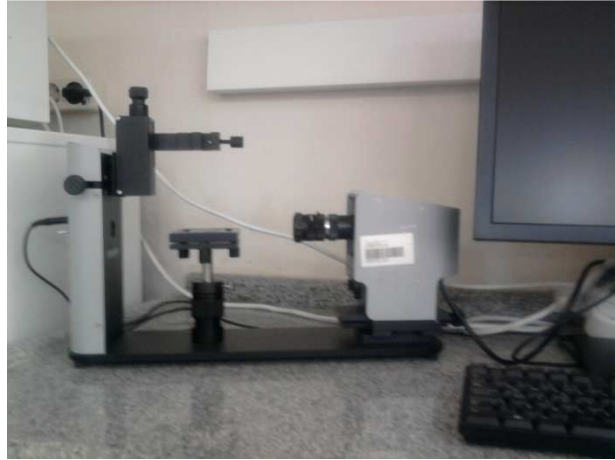
Şekil 3.2.3.5 Temas açısı ölçümlerinde kullanılan cihaz
