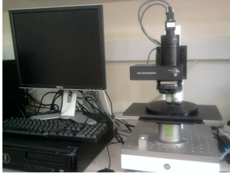
Şekil 3.2.4.1 Optik profilometre görüntülerini elde etmede kullanılan cihaz
