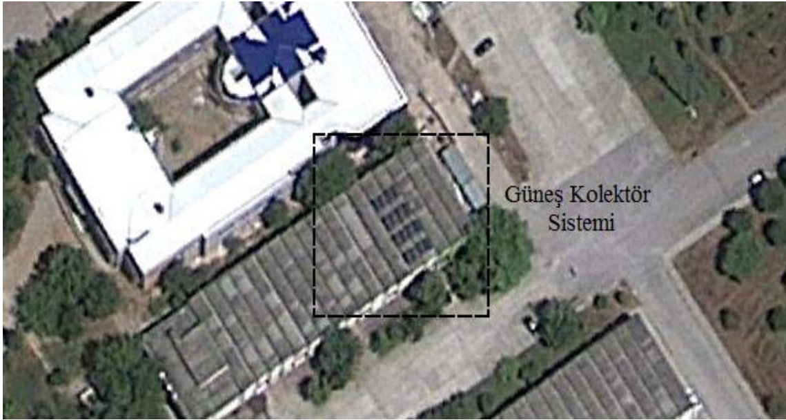
Şekil 3.14. Güneş kolektör sisteminin yerleşim özellikleri (Anonim 2011c.)
