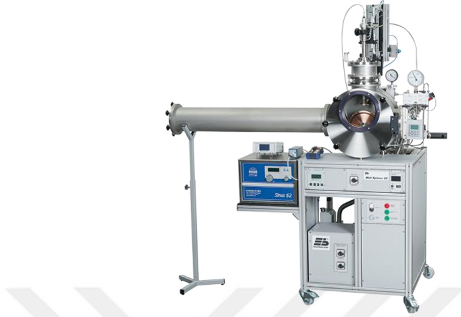
Şekil 3.5. Eriyik Eğime sistemi (Melt Spining)
