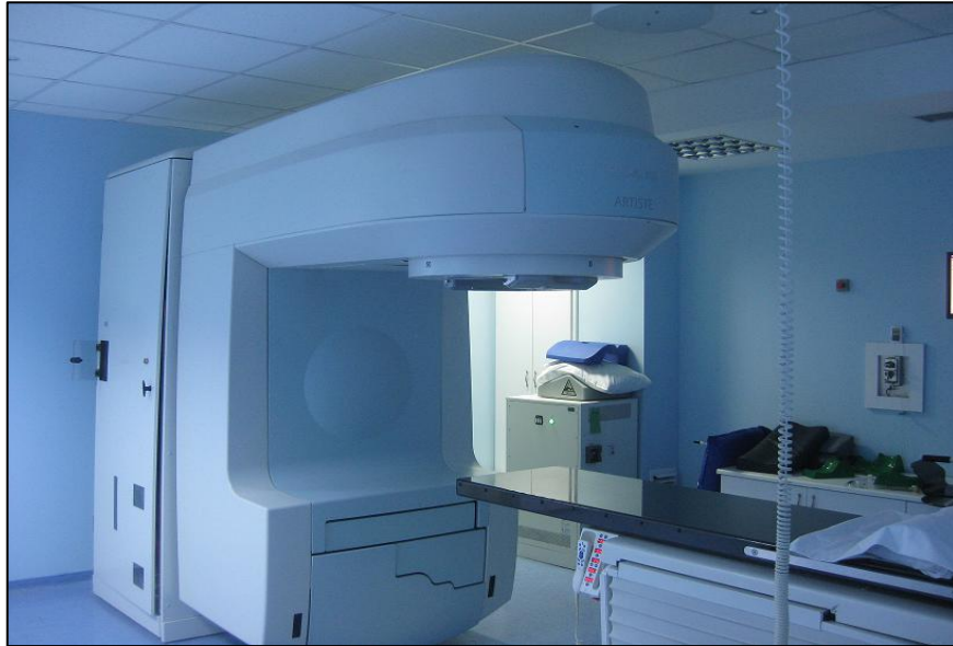
Şekil - 7: SIEMENS ARTISTE lineer hızlandırıcı cihazı.
