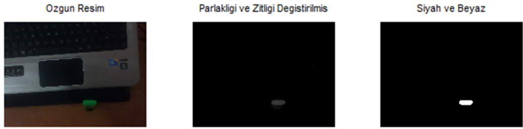
Şekil 3.35. Özgün resim ve eşik değeri işlemi sonucu
