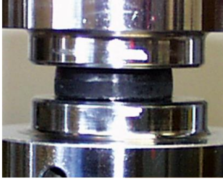
Şekil 3.3 Basit basma testi (Miller, 2000)
