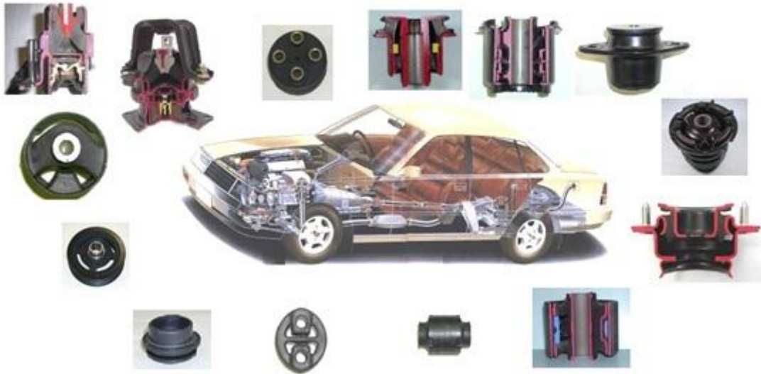
Şekil 2.5. Kauçuk parçaların otomobil üzerinde kullanıldığı yerler
