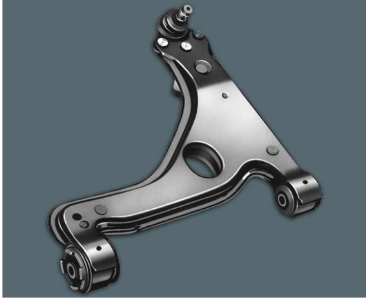
Şekil 2.8. Salıncak kolu üzerinde bulunan kauçuk burçlar
