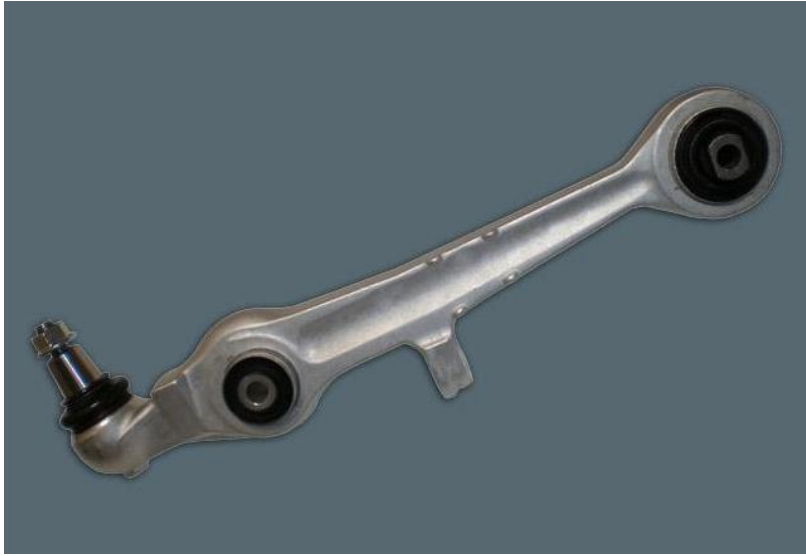
Şekil 2.9. Rotilli kol üzerinde bulunan kauçuk burçlar
