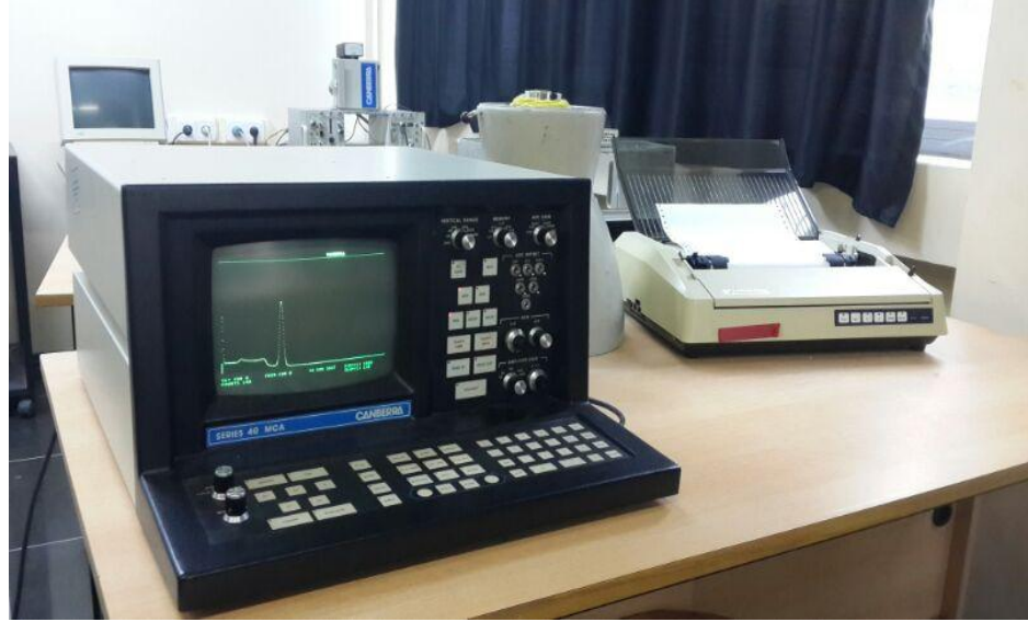
Şekil 3.1. NaI(Tl) detektörü ile ^{137}\text{Cs} ve ^{60}\text{Co} nokta kaynaklarına ait cevap fonksiyonlarının elde edilmesinde kullanılan deneysel sistem
