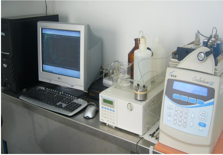
Şekil-18: Deneyler sırasında toplanan diyalizat örneklerinden dopamin ve DOPAC ölçümlerinin gerçekleştirildiği laboratuvarımızdaki HPLC sistemi.
