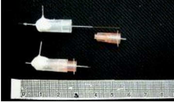
Şekil-14: Mikrodiyaliz probu ve Mikrodiyaliz kılavuz kanülünün son şekli. Şeklin üst kısmında yer alan Mikrodiyaliz probu, orta kısmında yer alan Mikrodiyaliz kılavuz kanülü, en altta yer alan ikisinin birlikte görüntüsü.
