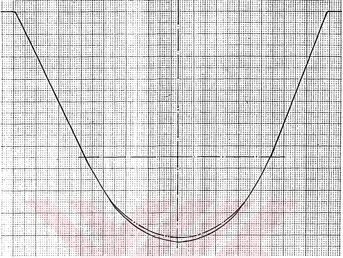
Şekil-56 N_T=0 ve N_T=250.000 Yük Tekrarından Sonra Döküm Poliamid Makara Yiv Profilinin Profil Kontrol Cihazında 10 Kat Büyütülmüş Durumu
