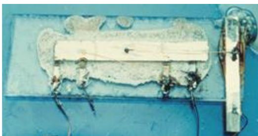
Figure 7 Le premier circuit intégré construit par Jack Kilby (Texas Instruments)
