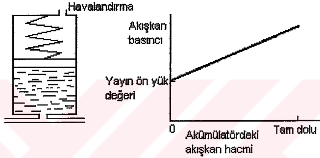
Şekil 1.2 Yaylı Akümülatör
