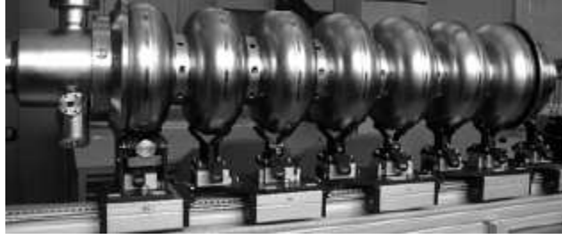
Şekil 2.3 Yüklü parçacıkların elektromanyetik alanlar yardımıyla hızlandırılmasını sağlayan süperiletken niobium malzemedan yapılmış RF kaviteler
