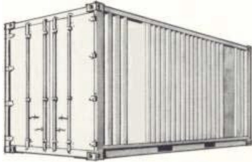
Şekil 11: Havalandırmazsız standart konteyner
