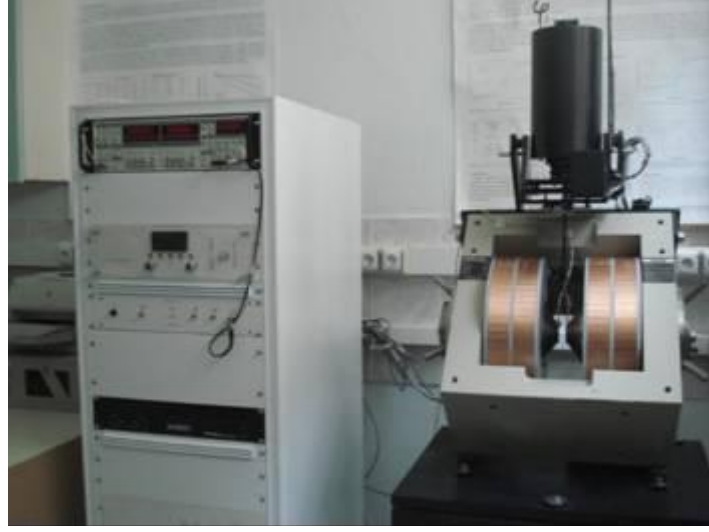
Şekil 3.7 Manyetik ölçümlerde kullanılan titreşimli örnek magnetometresi (VSM).
