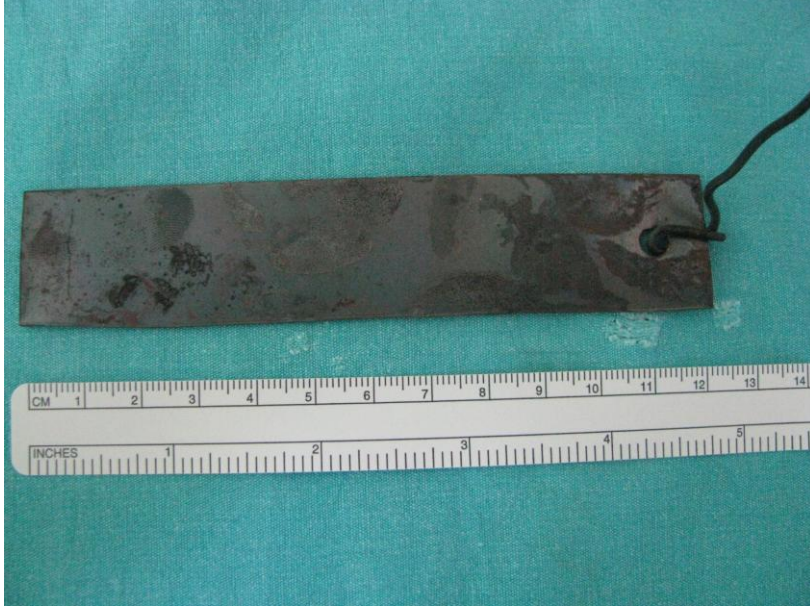
Resim-5: Termal yanık oluşturmak için tasarlanan metal plaka.
