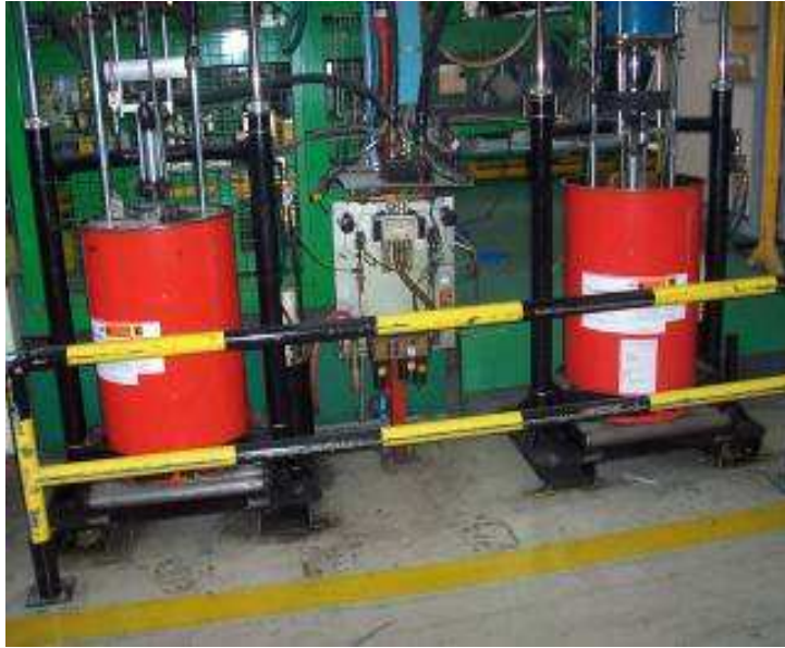
Şekil 4.6. Beş eksenli mastik makinasında epoksi kaplama çalışması
