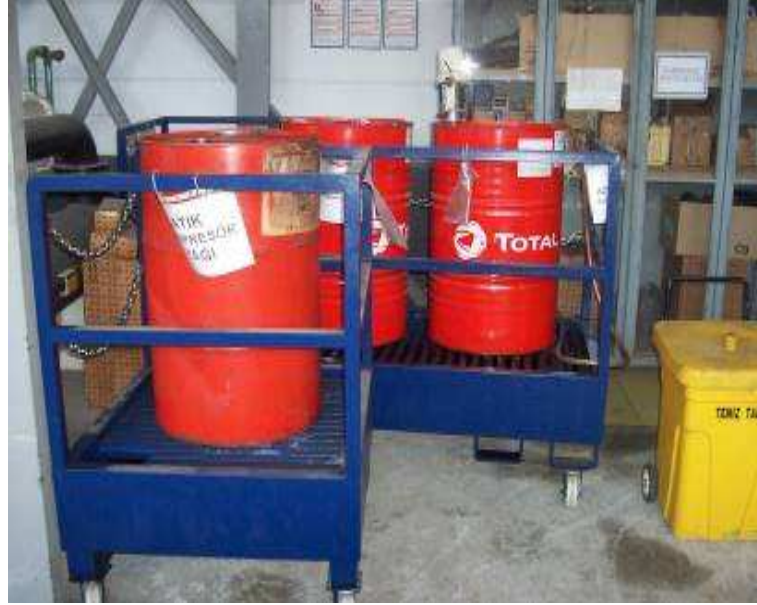
Şekil 4.13. Yağ depolama bölgesi zeminine konulan tutma haznesi
