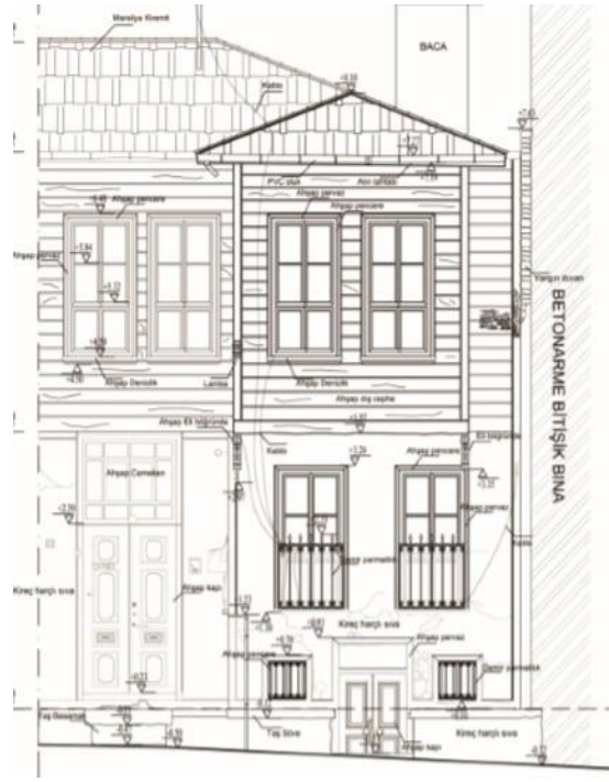
Şekil 129: K-38 Cephe Kesit
