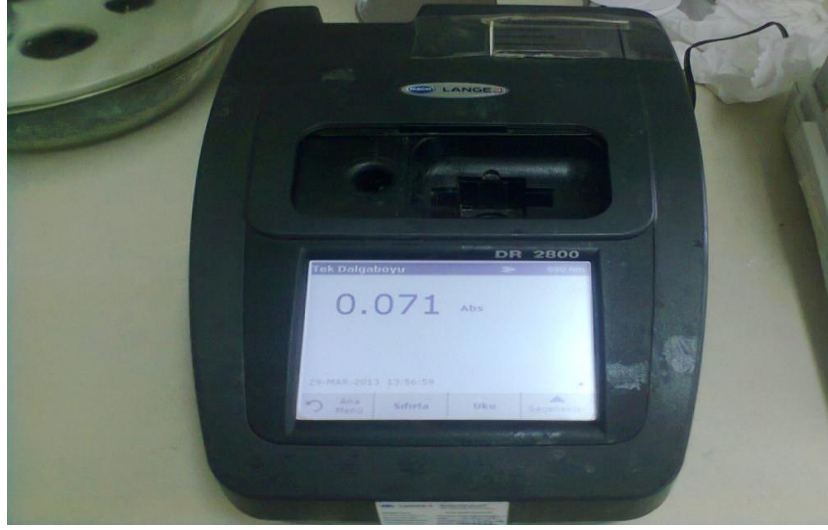
Şekil 3.8. Renk ve AKM analizlerinin gerçekleştirildiği spektrofotometre
