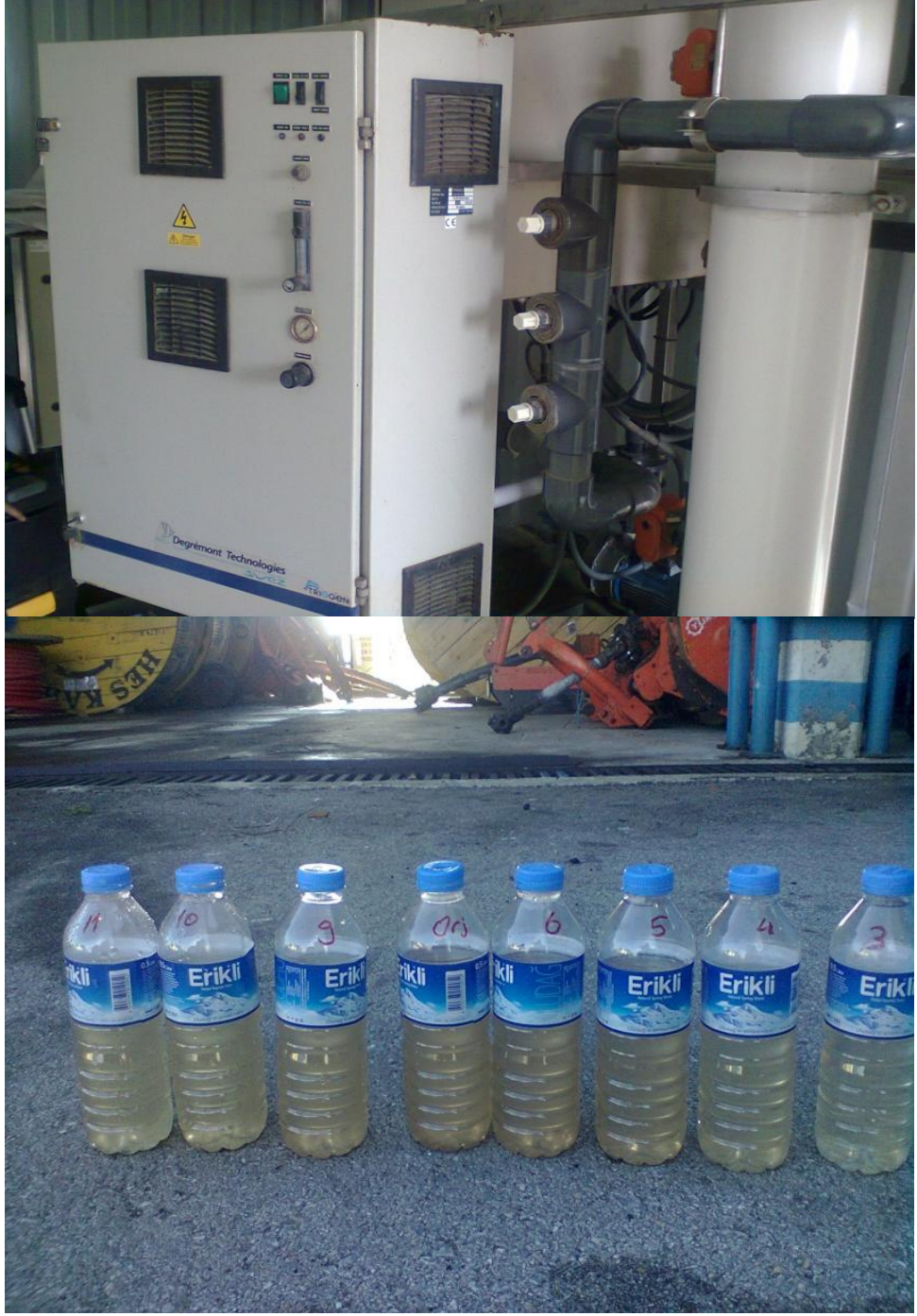
Şekil 3.4. Ozon oksidasyonu deneylerinde kullanılan pilot ölçekli ozon cihazı ve farklı pH'larda yapılan ozonlama sonuçlarında gerçekleşen renk değişimi
