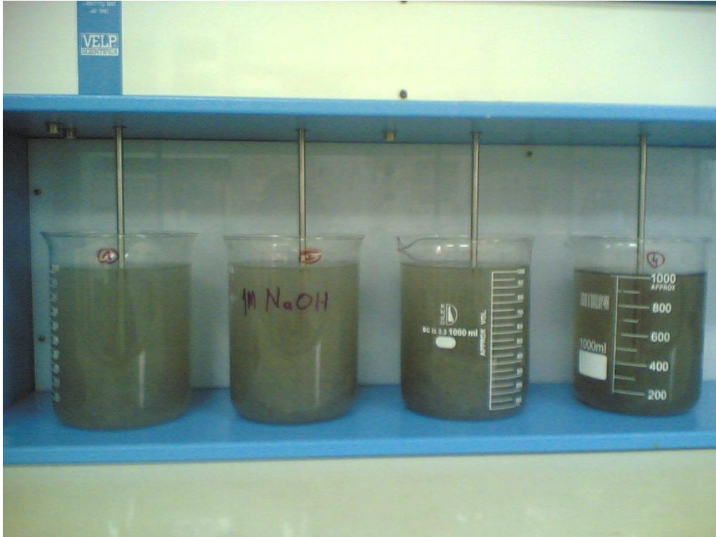
Şekil 3.2. Kimyasal koagülasyon ve Fenton ile Fenton-benzeri deneylerinde kullanılan Jar Test düzeneği
