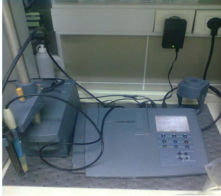
Şekil 3.7. WTW Series İno Lab pH/ion/Cond 750 Marka İletkenlik ve pH Ölçer
