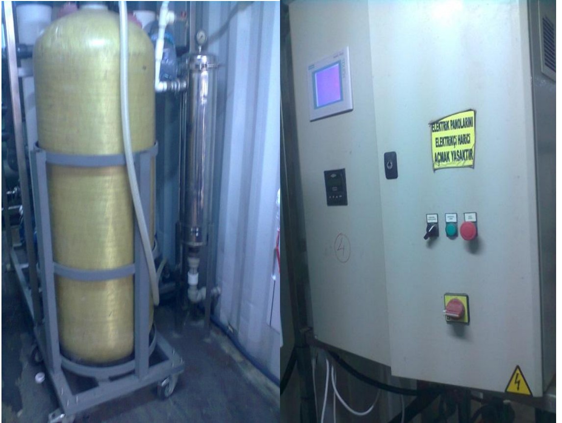
Şekil 3.6. Membran proseslerinde kullanılan pilot ölçekli BKF, MF ve UF cihazları
