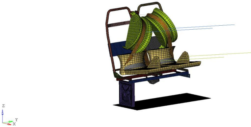
Şekil 4.36. Topografya optimizasyonu sonucu tip1 sac pres ayaklı koltuğun sonlu elemanlar modeli
