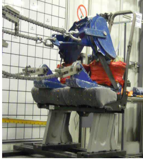
Şekil 3.4. Üç nokta emniyet kemer çekme testi
