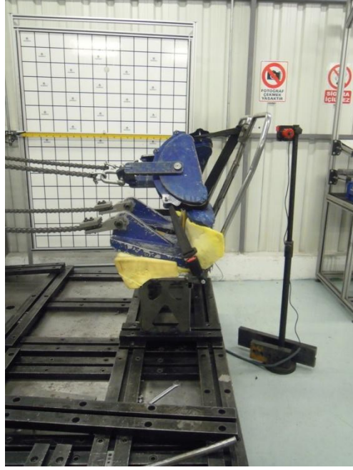
Şekil 4.31. ECE-R14 çekme testinde koltuğun yandan görünüşü
