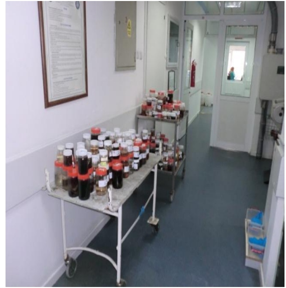
Şekil 3.18. Patoloji laboratuvarlarında yangın riski oluşturan uçucu alkol v.b maddelerin açıkta ve kaçış yollarının üzerinde depolanması
