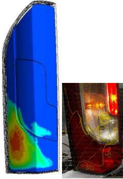
Şekil 4.50. Stop lambasında simülasyon ve test sonuçlarının karşılaştırılması
