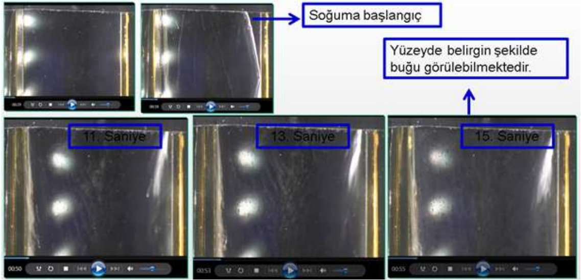
Şekil 4.17. Test esnasında yoğuşmanın zamana göre değişimi (Venchiarutti 2012)
