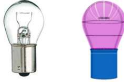
(a) Gerçek ürün (b) basitleştirilmiş data Şekil 4.4. Lambaların geometrik basitleştirilmesi
