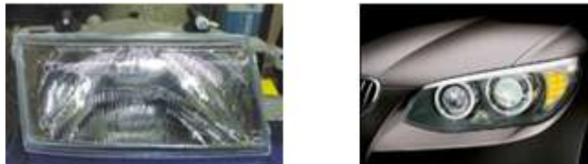
Şekil 1.17. Yarı saydam cam (sol) ve saydam plastik dış lens (sağ)
