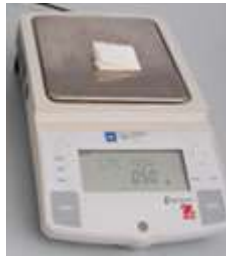
Şekil 4.13. Testte kullanılan hassas terazi (Venchiarutti 2012)
