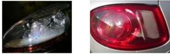
Şekil 1.16. Far ve stop lambasında meydana gelen yoğuşma
