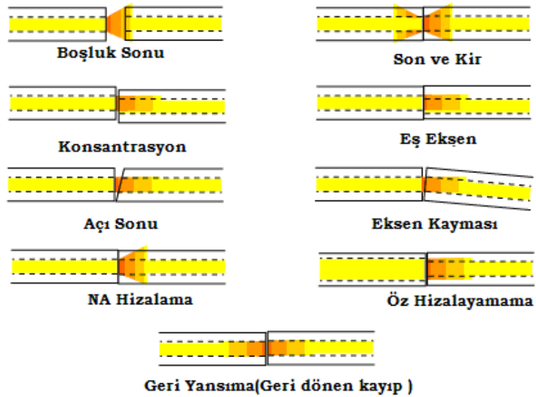
Şekil 4.4. Kaynatma-bağlaşım kayıpları ve ışının ilerleyişi
