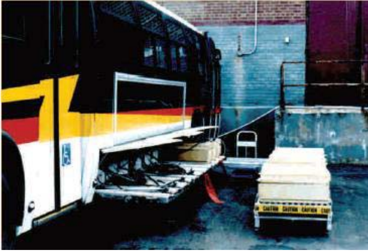
Şekil 4.27 Otobüse yerleştirilmeye hazır yakıtları yenilenmiş ÇHYP modülleri ( EFTC 2003 )
