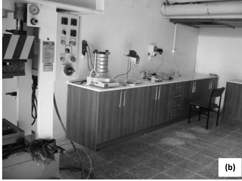
Şekil 3.2. Makine mühendisliğinde kurulan metal köpük laboratuvarı: (a) Pres (sıcak kalıp dâhil) ve fırın, (b) Elek, karıştırıcı ve terazi (devam)
