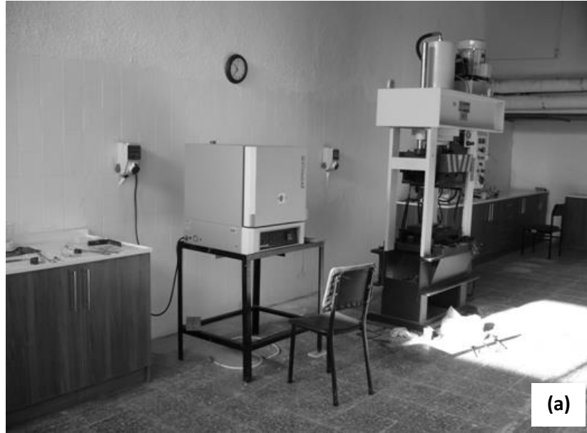
Şekil 3.2. Makine mühendisliğinde kurulan metal köpük laboratuvarı: (a) Pres (sıcak kalıp dâhil) ve fırın, (b) Elek, karıştırıcı ve terazi
