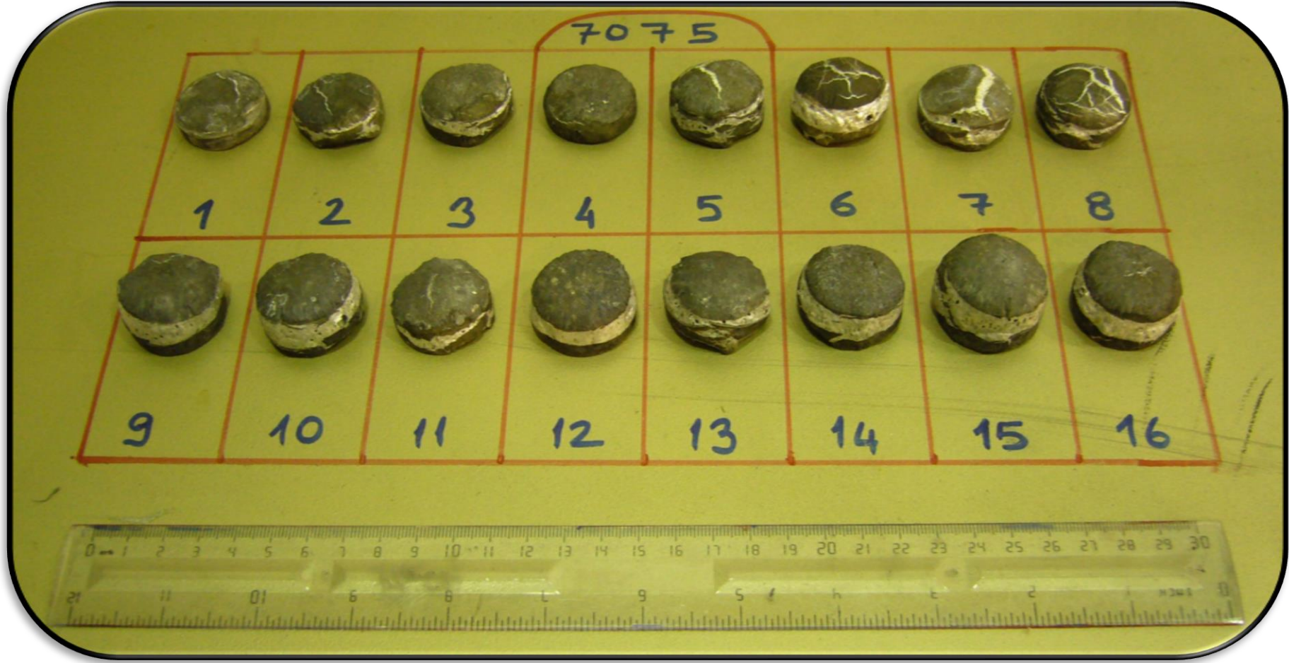
Şekil 4.10. Taguchi deneylerinde elde edilen 7075 alaşımı numunelerin birlikte görünümü
