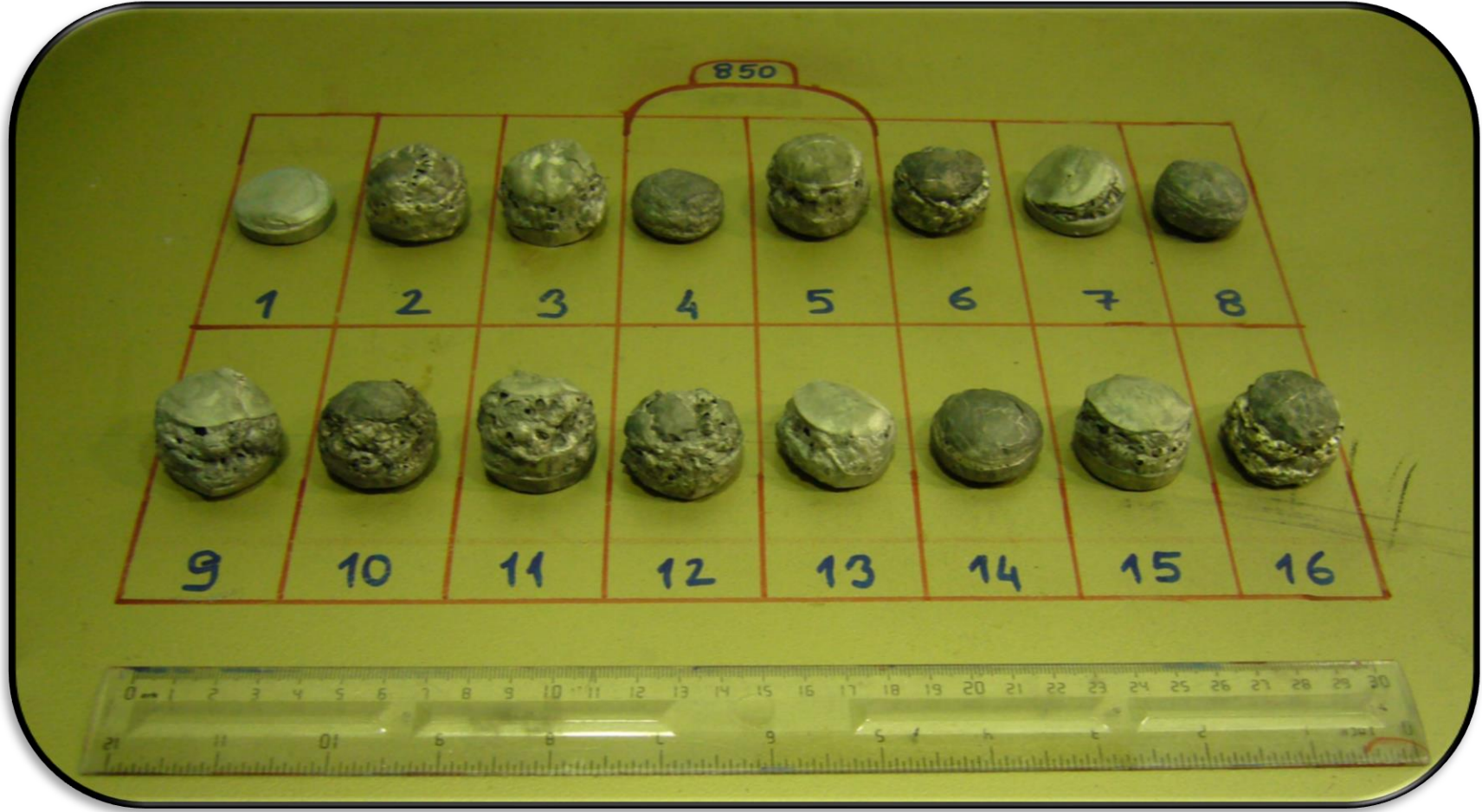
Şekil 4.4. Taguchi deneylerinde elde edilen 850 alaşımı numunelerin birlikte görünümü
