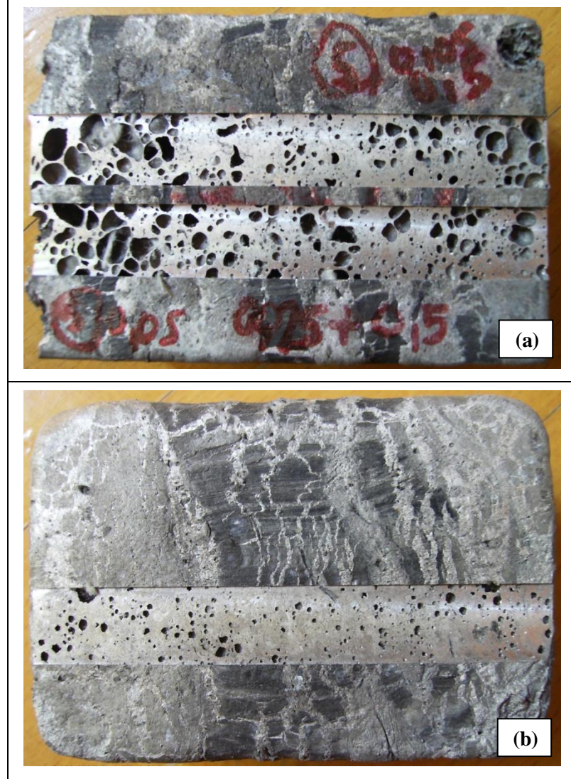
Şekil 4.59. İşlenmiş numunelerden örnekler: (a) % Cu=1,49; % Sn=3,08; % Ni=1,49; (b) % Cu=0,5; % Sn=3,08; % Ni=1,49
