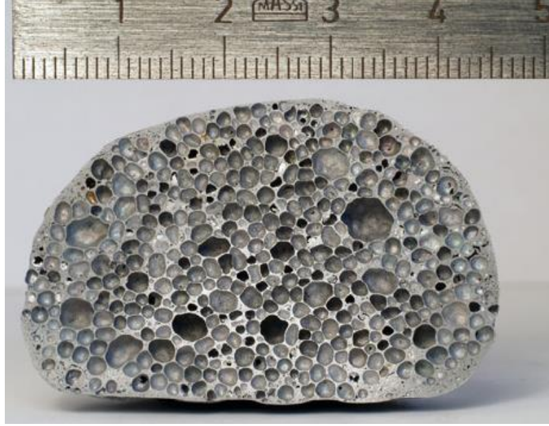
Şekil 2.1. Köpük halde AlMg 4 Si 8 alaşımı (Helwig ve ark. 2011)
