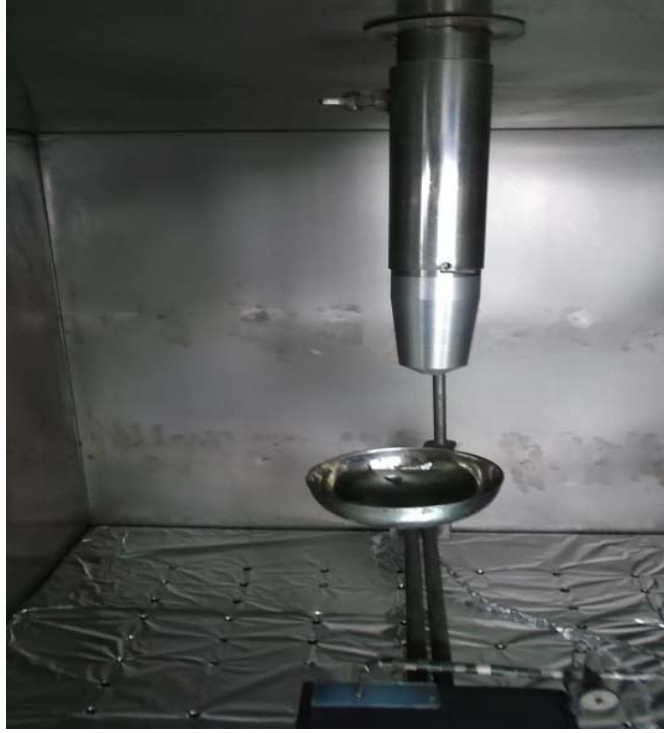
Şekil 3.6. UKP sisteminde püskürtmenin gerçekleştiği püskürtme başlığı
