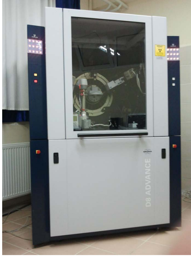
Şekil 4.5. X-ışını difraktometresi (Bruker marka D 8 Advance Model)
