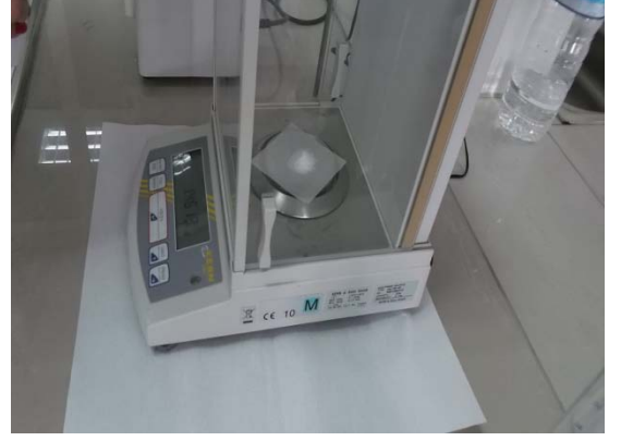
Şekil 3.5. Çözeltinin hazırlanması için kimyasalların hazırlanması ve tartılması
