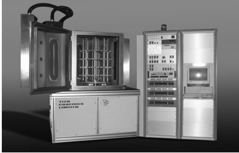
Şekil 5.12. PVD vakum kaplama makinesi örneği ( www.pvd-coatings.co.uk )
