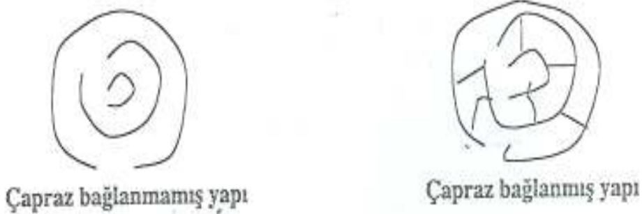
Şekil 2.1 Çapraz bağlanmamış ve bağlanmış polimer yapı (Anonim, 2001 )
