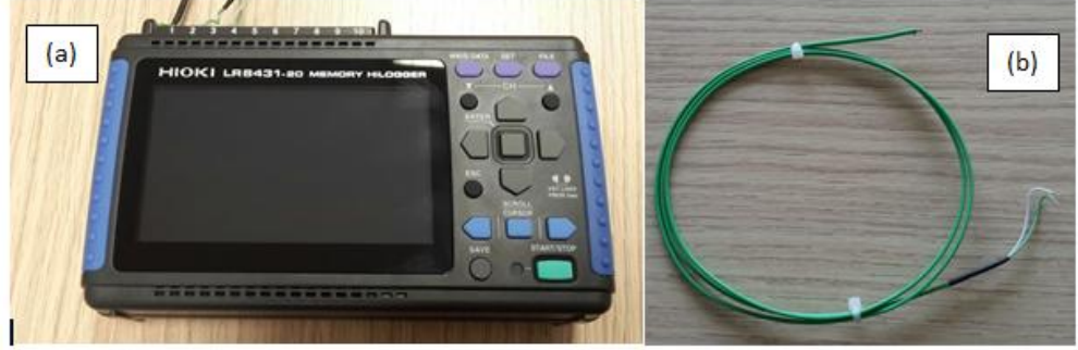
Şekil 3.8. (a) Hioki LR-8431-20 marka 10 kanallı veri kaydedici (b) K tipi termoelemanlar
