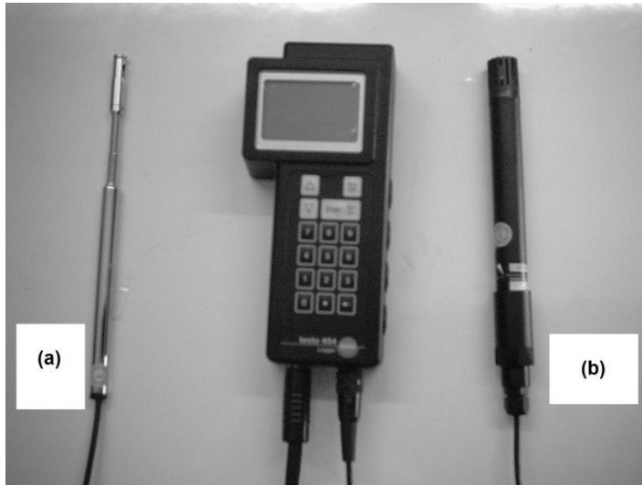
Şekil 3.6. Testo 454 veri toplama cihazı (a) hava hızı ölçüm probu (b) ortam sıcaklıęı ve baęıl nem ölçüm probu
