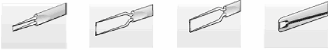
Şekil 3.10. Sensör tipleri a) Minyatür tel b) Altın kaplı tel c) Fiber film sensörü d) Film sensörü
