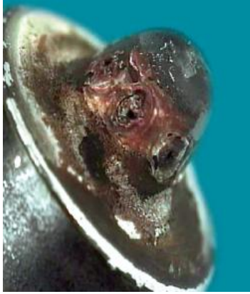
Őekil 2.14. Enjektör memesinde kurumlanma
