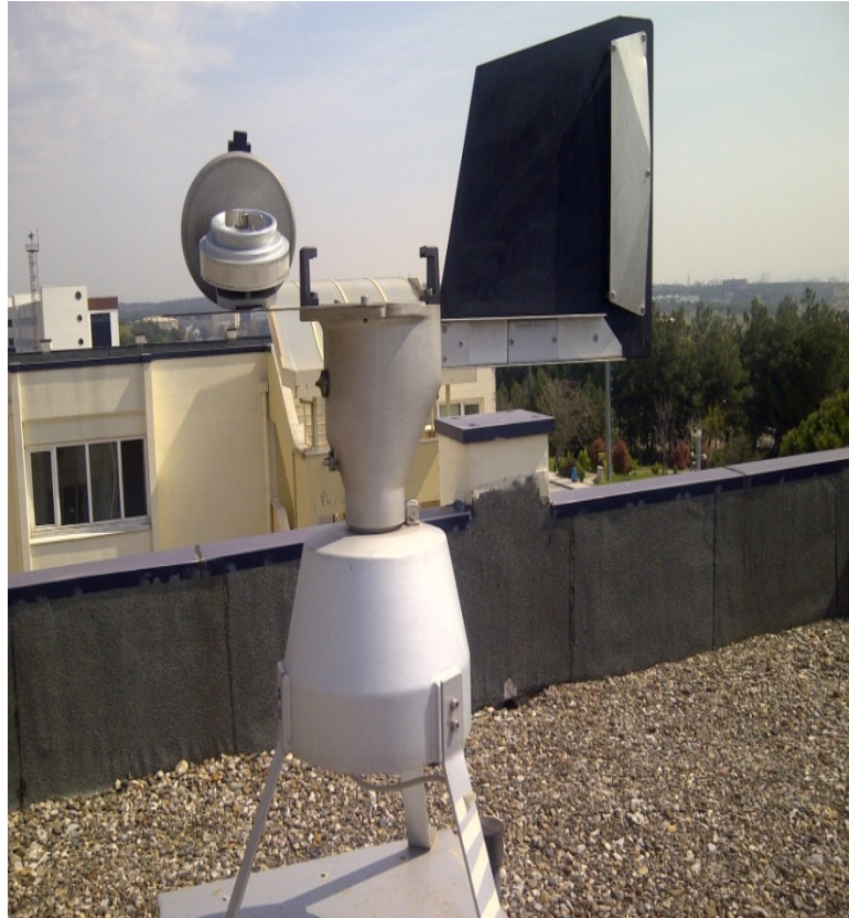
Şekil 3.1.2. Lanzoni marka VPPS 2000 cihazının ve diskin genel görüntüsü
