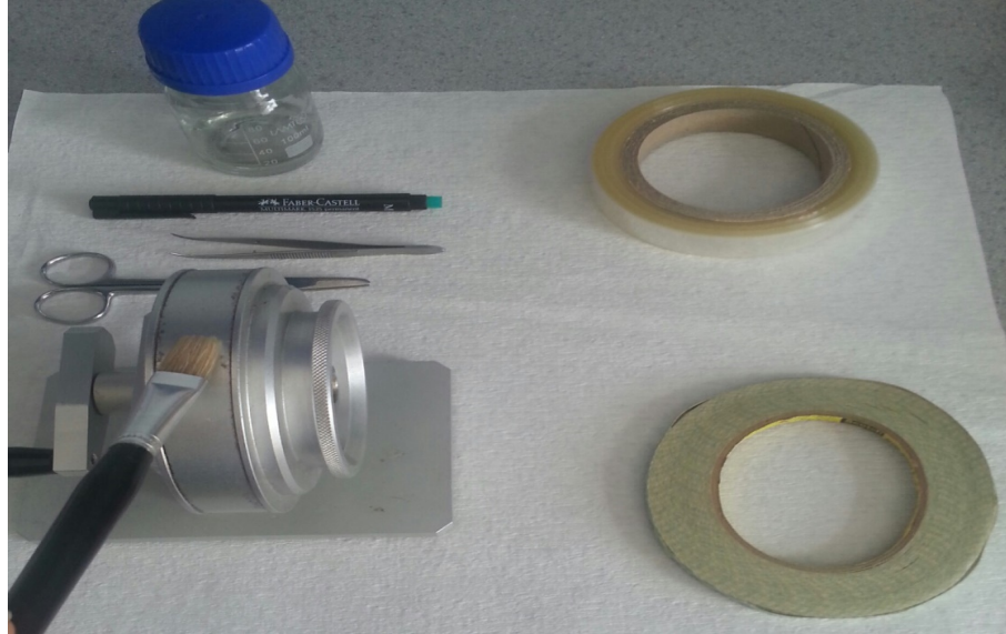
Şekil 3.4.1. Melineks bant üzerine silikon solüsyonunun sürülmesi
