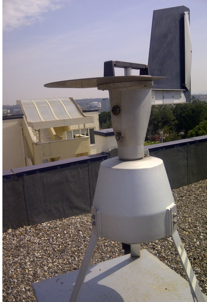
Şekil 3.1.1. Çalışmada kullanılan polen ve partikül toplama cihazı (Hirst trap).
