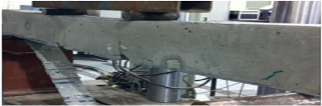
Şekil 5.3. BC Kirişinin Yük Altında Deformasyonu (Hawileh ve ark. 2014)
