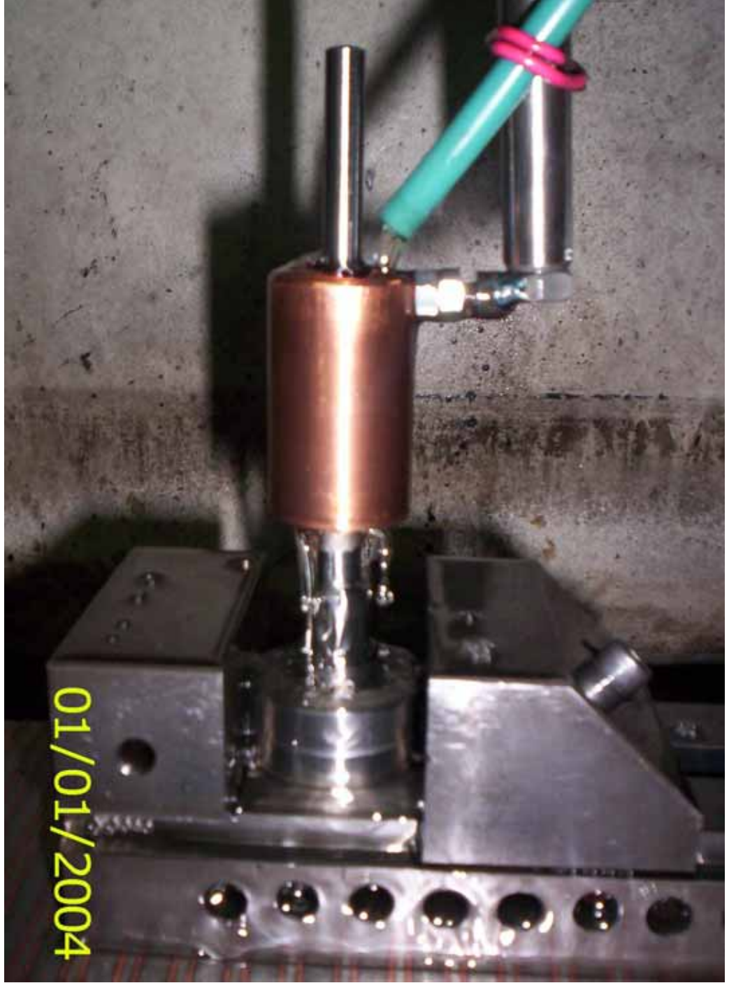
Şekil 3.27. EDM metodu ile işleme yönteminden bir görüntü
