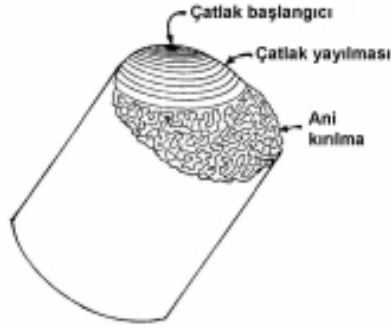
Şekil 3.12. Çatlağın başlangıç, yayılma ve ani kırılma bölgeleri (Meyers, Chawla, 1999).
