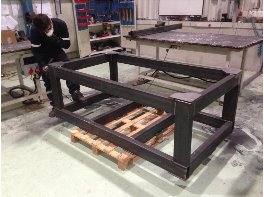
Şekil 2.26. Profillerin kaynatılarak karkas haline getirilmesi
