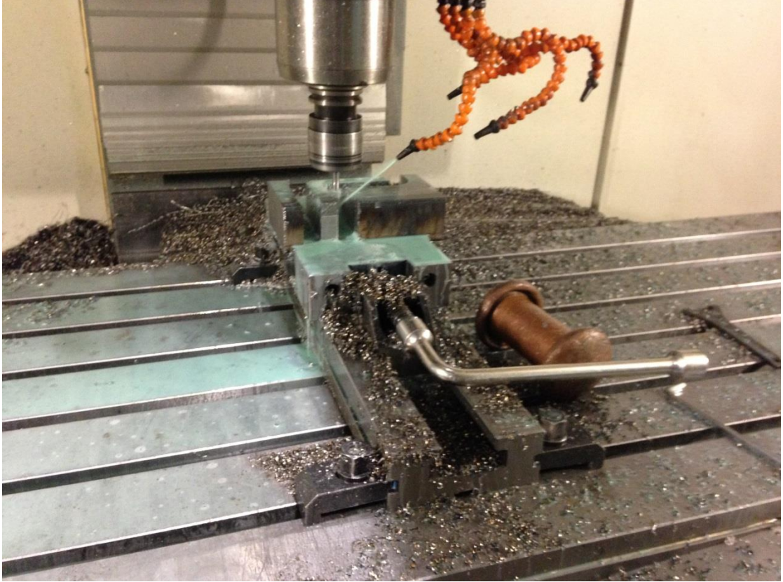
Şekil 2.25. Kullanılacak ürünlerin CNC’de işlenmesi
