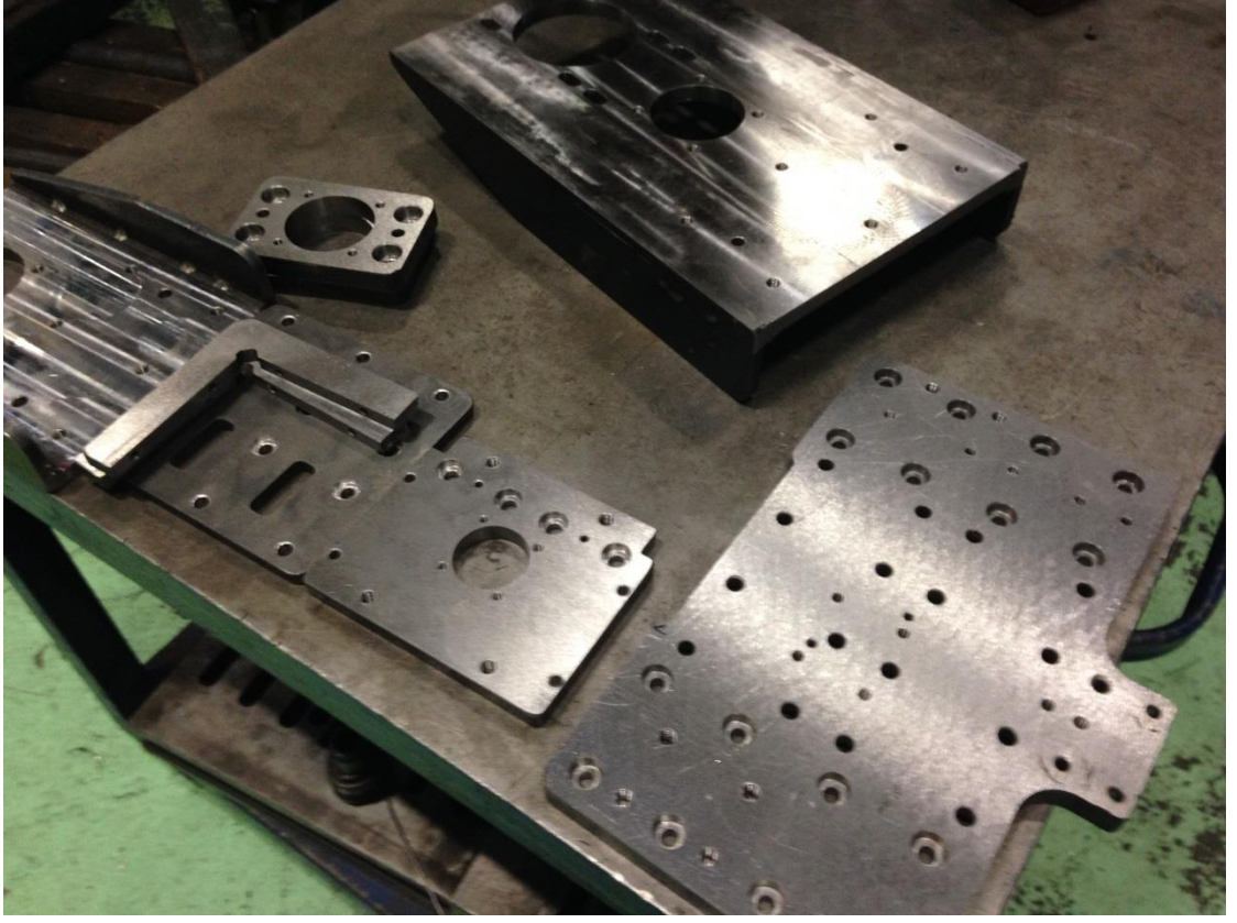
Şekil 2.27. Hassas olarak işlenen sac parçalar
