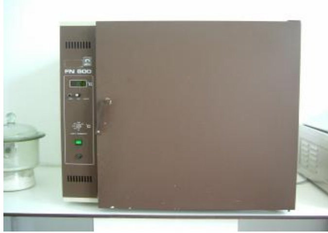
Şekil 3. Nem tayininde kullanılan etüv
