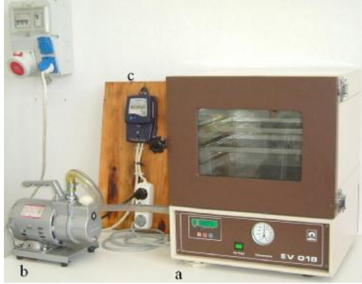
Şekil 6. Vakumla kurutma düzeneği a) Vakumlu etüv b) Vakum pompası c) Elektronik sayaç
