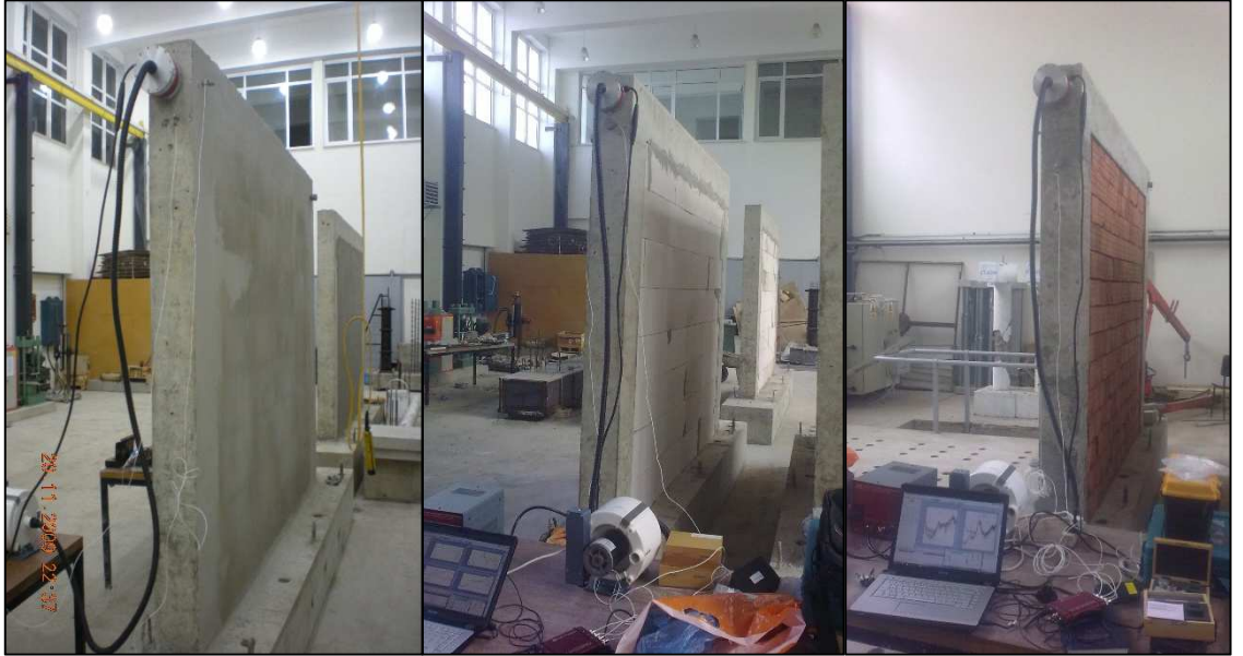
Şekil 5.14. Operasyonel modal analiz yapılırken farklı görünüm
