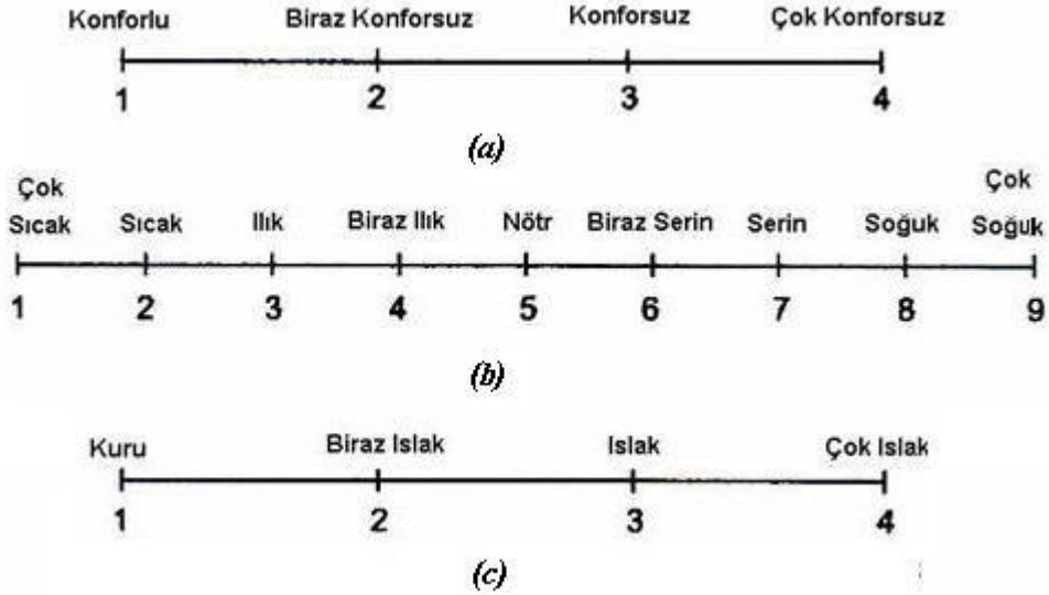
Şekil 2.3. a) Konfor b) Termal his c) Nem hissi için hazırlanan sübjektif değerlendirme skalaları (Ruckman ve ark. 1999)
