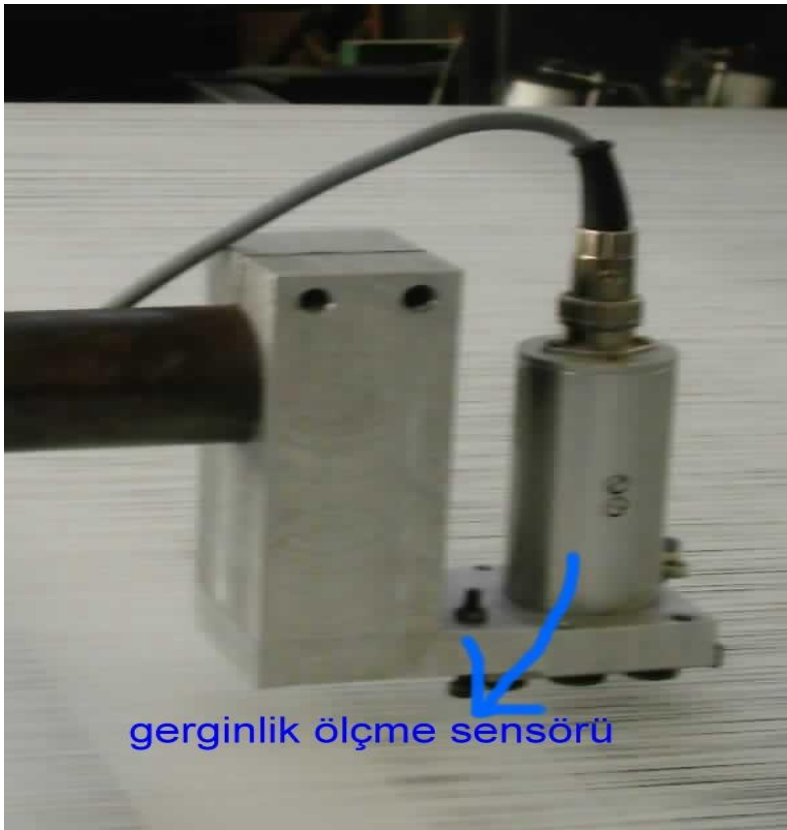
Şekil 3.3. Gerginlik ölçer ve dokuma makinası.
