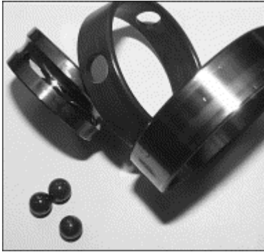
Şekil 2.11. Tribolojik denemeler için özel rulmanlar: iç bilezik, kafes, dış bilezik ve üç seramik bilya.
