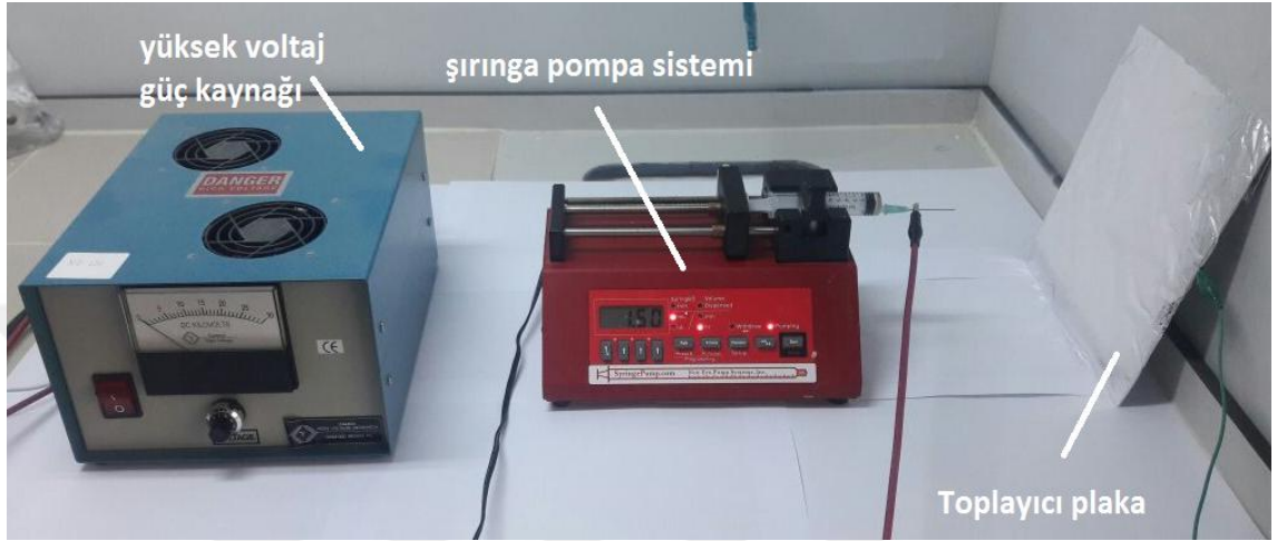
Şekil 3.2. Elektro çekim işleminin yapıldığı cihaz ve aparatlar (Aladağ 2016).
