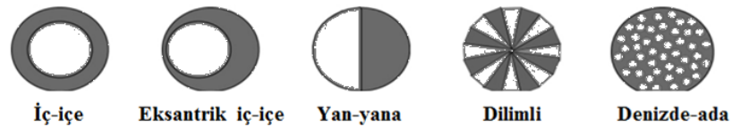
Şekil 2.4. Çeşitli bikomponent liflerin enine kesit görüntüleri (Anonim 2017c)
