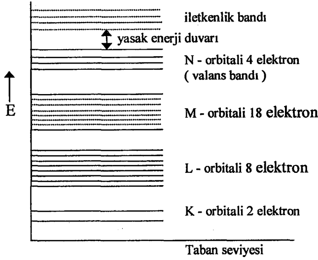
Şekil 2.1 Germanyum atomu için orbitallerin elektronlarla doldurulması.
