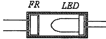
Şekil 2.59 LED - fotodirenç çiftinin kılıf içerisine yerleştirilmesi.
