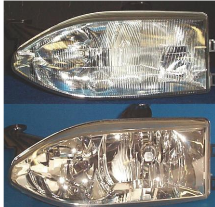
Şekil 12. Eski tip lens üzeri optik ile yeni tip reflektör üzeri optik yüzey
