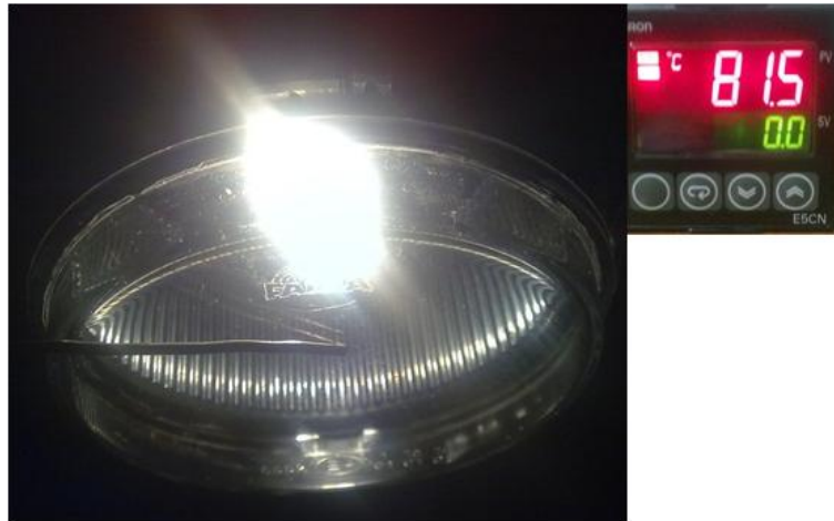
Şekil 65. Al. kaplamasız siyah lambanın lens dış yüzeyi maksimum sıcaklık ölçümü
