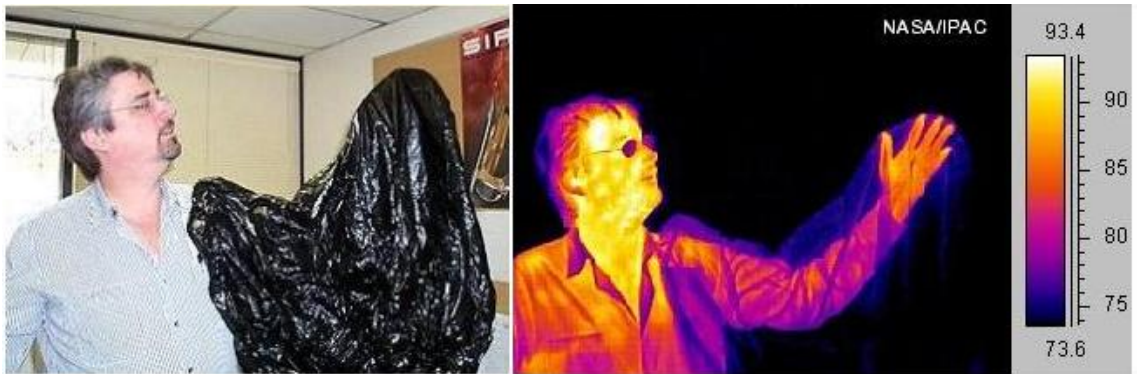
Şekil 28. Gözlük camının ve plastik poşetin görülebilir ve kızılötesi dalga boylarındaki geçirgenlik özellikleri
