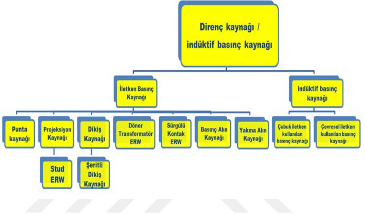
Şekil 2.40. DIN 1910-5 'e göre direnç kaynağı türleri
