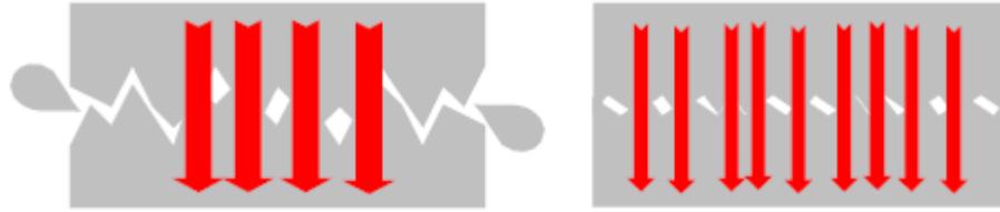
Şekil 2.24. Yüzey pürüzlülüğünün kaynak akımına etkisi (David Steinmeier, Laser and Resistance Weldability Issues, Part II – Material Surface Properties, 2003)
