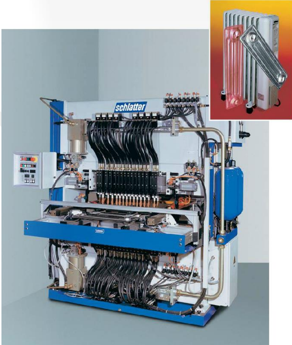
Şekil 2.46. Panel radyatör imalatında kullanılan çoklu punta kaynak makinesi (Schlatter AG, 2015)
