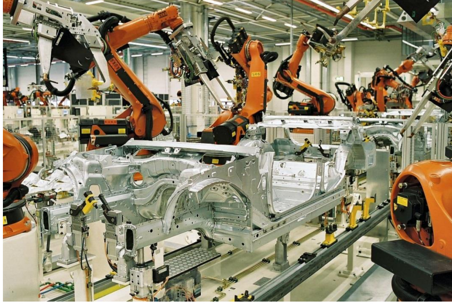
Şekil 2.43. BMW 3 Serisi araçların gövdelerinde kullanılan robot otomasyonlu punta kaynak makineleri (Wikipedia, 2015)
